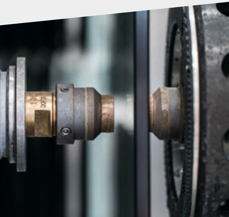
Perçage avec utilisation de deux têtes.
