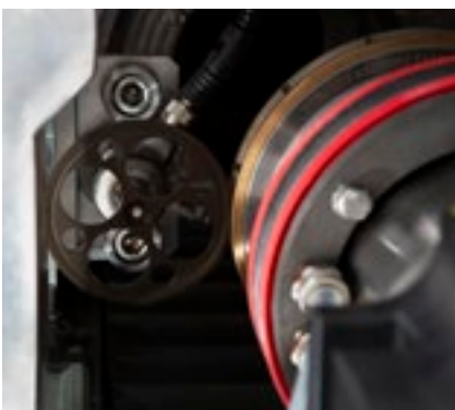
Préréglage des meules diamantées.
