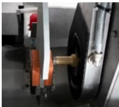
Système de mesure et de ravivage des forets intégré dans la configuration de base de la machine.
